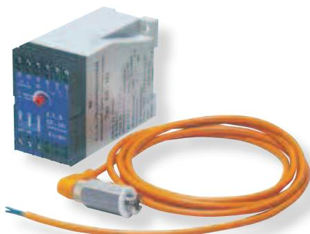
Dans le cas d'une défaillance de la membrane, le produit pompé pénètre dans la chambre d'air et déclenche le capteur. Le capteur envoie ensuite une impulsion électrique au dispositif de surveillance pour évaluation. L'unité de commande stoppe l'alimentation en air du distributeur d'air, entraînant alors l'arrêt du fonctionnement de la pompe.
