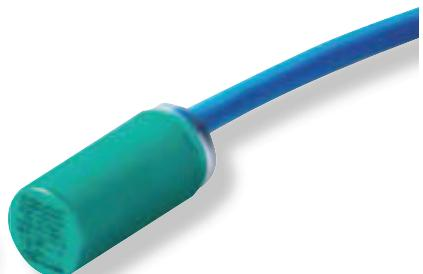
Le capteur du compteur de pulsations compte chaque cycle du mouvement de la membrane. Le débit de refoulement peut être déterminé en multipliant le nombre de cycles par les volumes de chambre de pompe. Le compteur de coups permet une mesure et un contrôle précis pour les applications de dosage.
